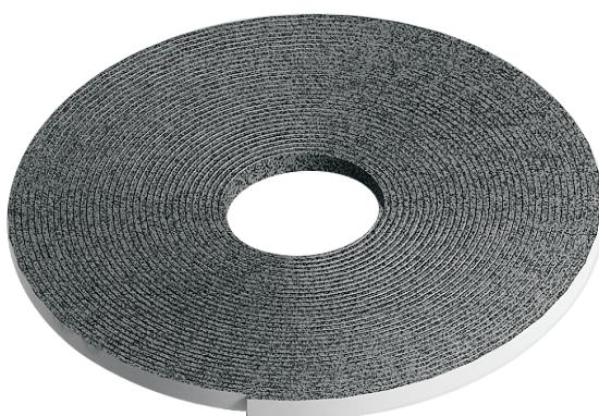
Лента самоклеящаяся ТИЛИТ® Супер СК из вспененного полиэтилена обладает низким коэффициентом теплопроводности ( $\lambda = 0,035 \text{ Вт}/(\text{м} \cdot \text{°C})$ ) и предназначена для изоляции фитингов, арматуры и труднодоступных участков трубопроводов в системах отопления и водоснабжения, а также для уплотнения различных соединений.
